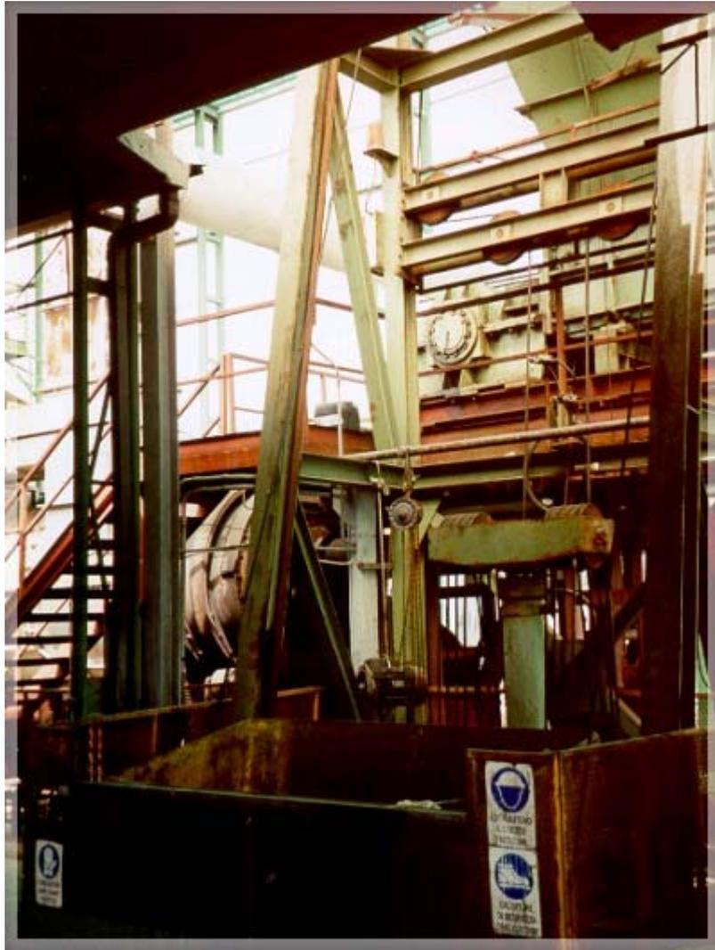
Figure 5. Punto di alimentazione del rifiuto: elevatore, tramoggia, trituratore
